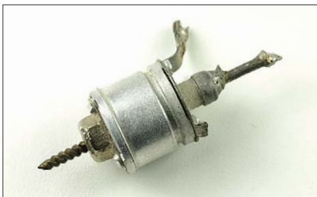
Bild 48: Außenansicht eines zusammenschraubten Lufttrimmers
