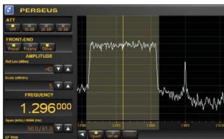
Bild 9: Das Bild zeigt ein DRM-Signal der BBC im Spektrum auf der Mittenfrequenz 1296 kHz. Rechts daneben ist ein AM-Signal zu erkennen. Bilder: Werkfotos (2), DE8JOI (7)
