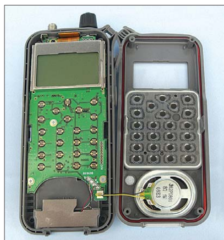
Bild 5: Nicht viel zu sehen gibt es nach dem Öffnen des Gehäuses. Ganz unten unter der Abdeckung befindet sich die Ferritantenne.
