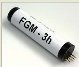
Sensor für das Fluxgate-Magnetometer nach FA 10/08
