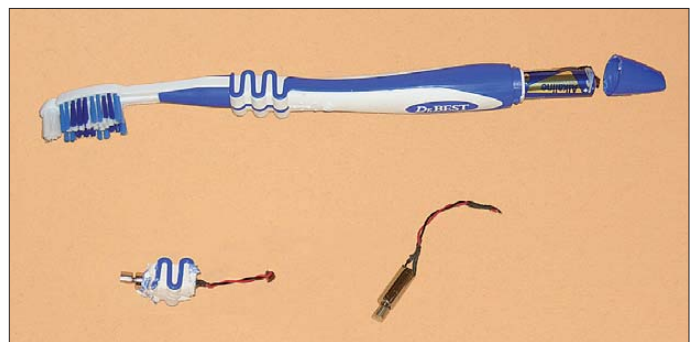
Bild 8: Echtes Recycling: einen Vibrationsmotor können wir aus einer billigen elektrischen Zahnbürste gewinnen.
