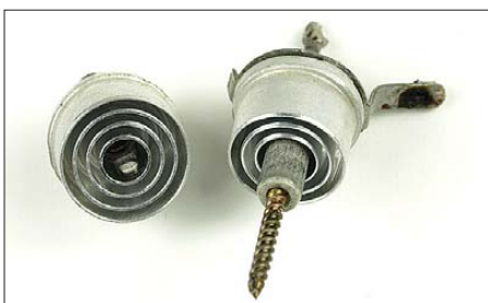
Bild 49: Hauptbestandteile des Lufttrimmers aus Bild 48
