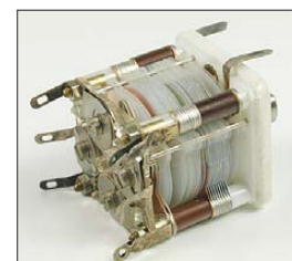
Bild 38: Ein Mehrfachdrehkondensator mit Folie als Isolator
