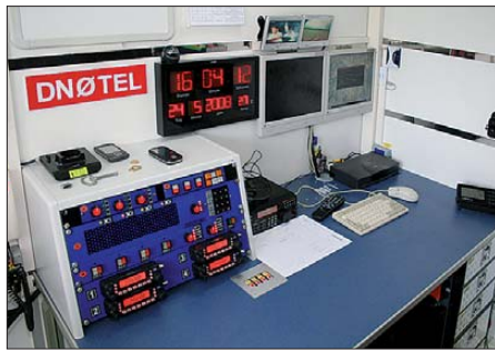
Arbeitsplatz in der mobilen Funkeinheit: Ausgestattet mit 4 x Dualbander 2 m/70 cm, DVB-T-Empfang, Monitor der Mastkamera, Wetterstation, zwei PC-Monitore (Logbuch, APRS oder auch SSTV) sowie Drucker für die Einsatzunterlagen
