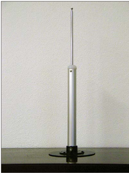
Bild 9: Antennenstab einer Aktivantenne mit Operationsverstärker nach Bild 10
