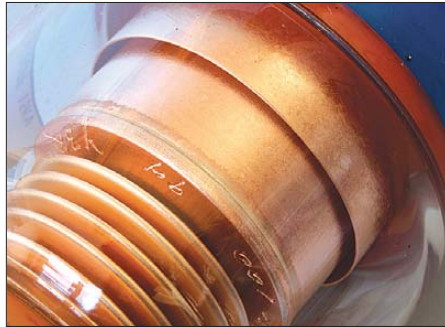
Bild 52: Konzentrischer Zylinder des Vakuumdrehkondensators aus Bild 51
