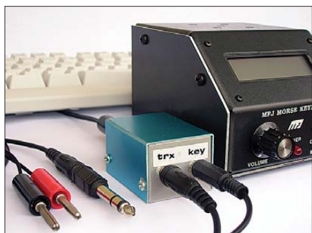
Bild 1: Ansicht des Interfaces im Aluminium-Kleingehäuse, daneben die CW-Steuerelektronik des MFJ-452 und im Hintergrund die Tastatur; die Betriebsspannung wird auf der Rückseite zugeführt. Auf der Frontseite ist Platz für die Buchsen zum Transceiver und zur Taste. Foto: DF9GH
