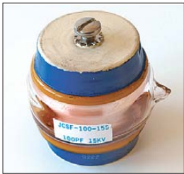
Bild 47: Vakuumpendelkondensator mit fester Kapazität Fotos: DJ3TZ
