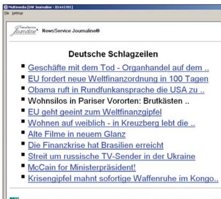
Bild 8: Der Software-Decoder DREAM bringt die mit Journaline per DRM-Signal gesendete Textnachrichten auf den Bildschirm.
