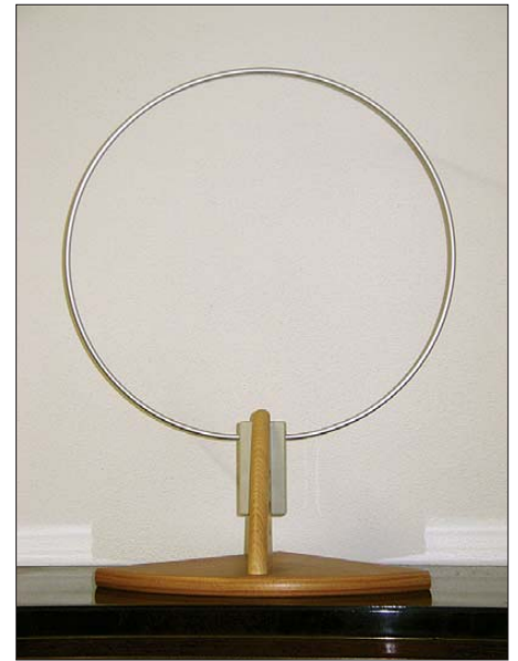
Bild 11: Ansicht der Schleifenantenne der Aktivantenne mit OPV nach Bild 12
