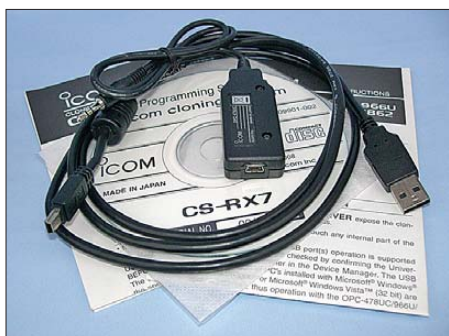
Bild 8: Zur einfacheren Verwaltung der vielen Speicherplätze mit dem PC dienen das als Zubehör erhältliche Programm CS-RX7 mit dem Adapter OPC-478UC für USB oder wahlweise OPC-478 für die serielle Schnittstelle.
