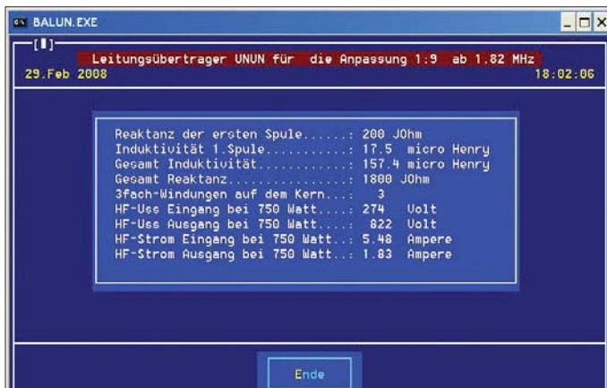
Bild 9: Rechenergebnis für den Leitungsübertrager 1:9 in Bild 8
